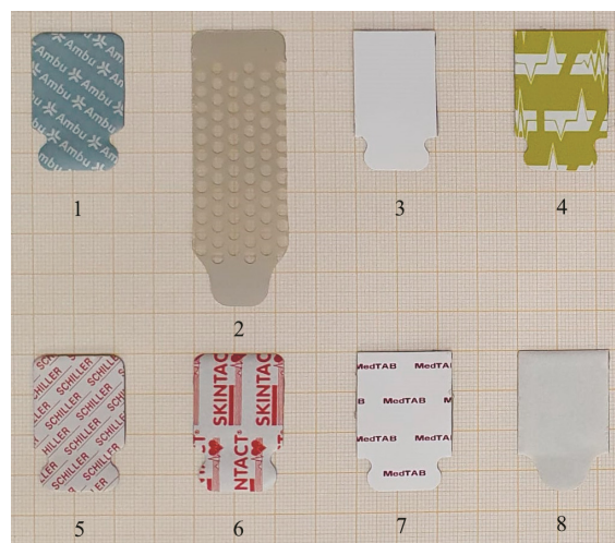
Рисунок 2. Самоклеящиеся биоадгезивные электроды, использованные при измерениях биоимпедансным анализатором ABC-01 «Медас»: 1 – Ambu White Sensor 0415M (Ambu, Дания), 2 – Bianostic AT (Data Input, Германия), 3 – Eurotrode PFR2034 (Pirrone srl, Италия), 4 – F9049/RU2234TAB (FIAB, Италия), 5 – Schiller biotabs 23×34 мм (Schiller, Швейцария), 6 – Skintact RT-34 (Leonhard Lang GmbH, Австрия), 7 – Top Trace MedTab (Ceracarta, Италия), 8 – 2100 Swaro-tab (Tyrolmed, Австрия) Figure 2. Bioadhesive electrodes used in measurements with the ABC-01 "Medas" bioimpedance instrument: 1 – Ambu White Sensor 0415M (Ambu, Denmark), 2 – Bianostic AT (Data Input, Germany), 3 – Eurotrode PFR2034 (Pirrone srl, Italy), 4 – F9049/RU2234TAB (FIAB, Italy), 5 – Schiller biotabs 23×34 mm (Schiller, Switzerland), 6 – Skintact RT-34 (Leonhard Lang GmbH, Austria), 7 – Top Trace MedTab (Ceracarta, Italy), 8 – 2100 Swaro-tab (Tyrolmed, Austria)
