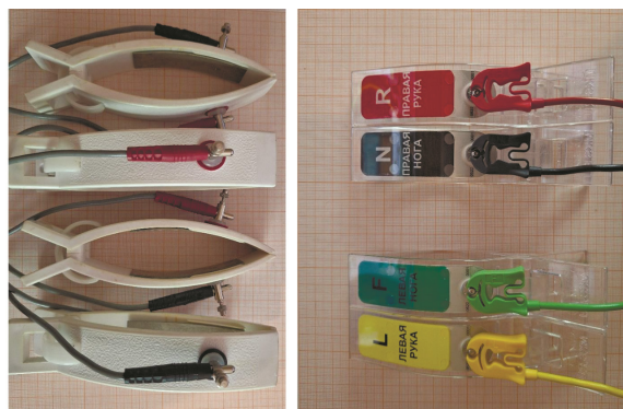
Рисунок 1. Многоцветные электроды для биоимпедансных измерений производства ООО «Диамант» (слева) и ООО «МКС» (справа) Figure 1. Reusable electrodes for bioimpedance measurements manufactured by Diamant LLC (left) and MCS LLC (right)
